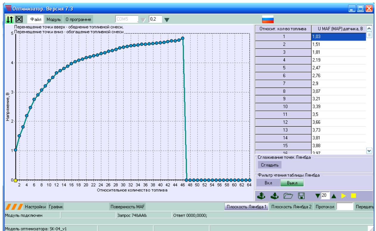
Рисунок. 5.2. Точки и кривые, выводимые на график эмулятора: *желтые – текущие данные; синие – записанные в оптимизаторе в процессе обучения; зеленые – отредактированные пользователем.*
