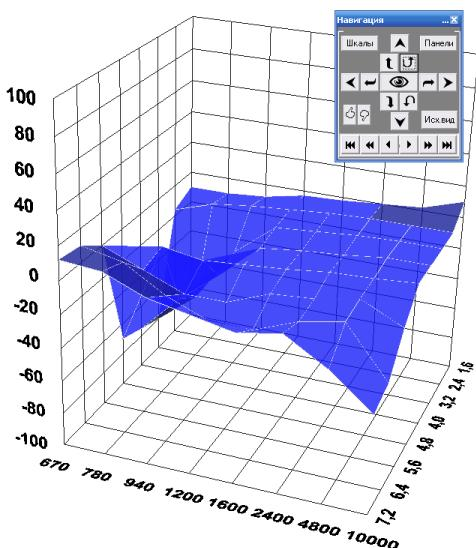
Имеется возможность производить воспроизведение сигналов в зависимости от частоты вращения, времени впрыска, расхода воздуха. Таблица коррекции построена в виде матрицы 8x8. Столбцы матрицы всегда соответствуют частоте вращения. Строки матрицы соответствуют времени впрыска топлива или расходу воздуха (напряжение от MAF (ДМРВ)). Выбор режима строк осуществляется при помощи переключателя (см. рис. 5.4.).
