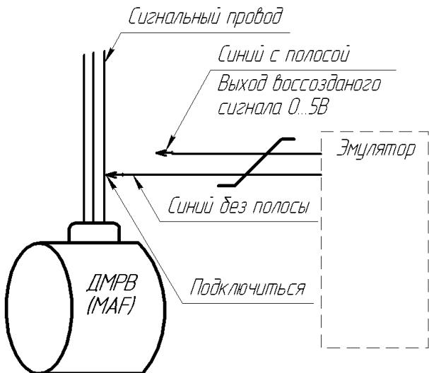
Если у Вас установлен ДМРВ с импульсным выходом, до подключения оптимизатора запустите двигатель и измерьте частоту импульсов от ДМРВ на холостых оборотах и при сильных перегазовках (функция измерения частоты есть на многих цифровых мультиметрах). Если частота на каких-либо режимах превысила значение 1000Гц, нужно отметить в настройке «Диапазон частот ДМРВ – более 1КГц».
