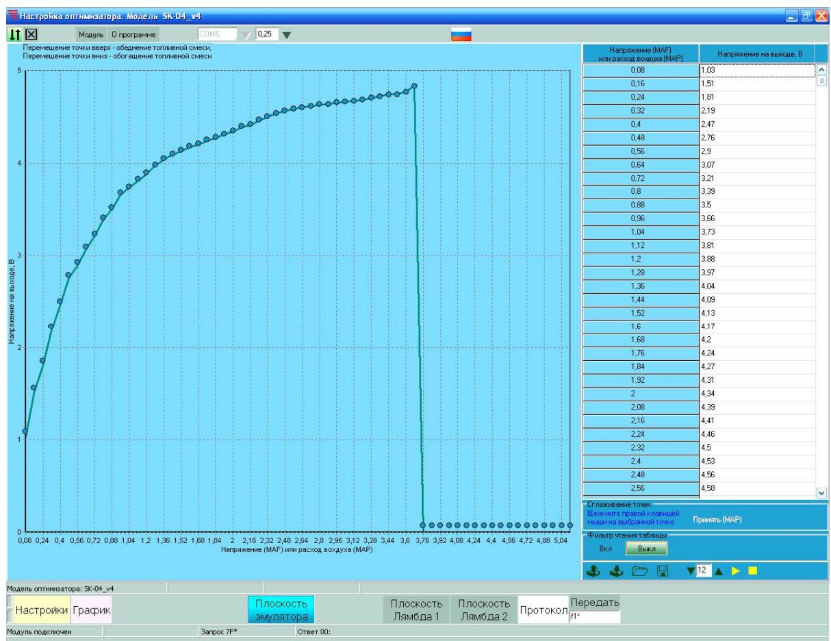
Таблица эмуляции MAF строится на основании количества воздуха (значения в условных единицах). К каждой точке количества воздуха привязывается соответствующее этому расходу напряжение MAF.
